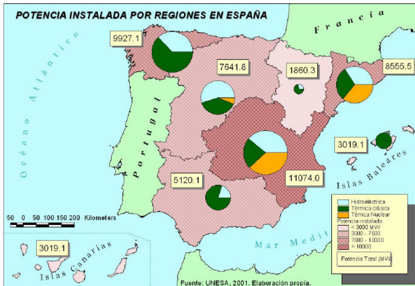
Ilustración 3-17: Potencia eléctrica instalada en España. UNESA.
