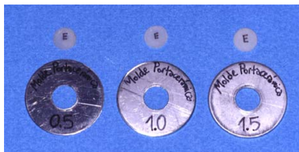
Figura 23. Moldes cilíndricos de acero y discos cerámicos
