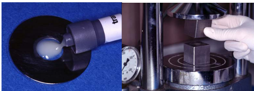
Figura 26. Rellenando el reservorio con cemento y prensándolo
