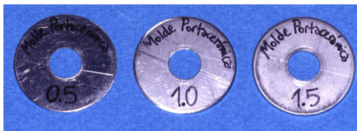
Figura 13. Moldes portacerámica de acero
