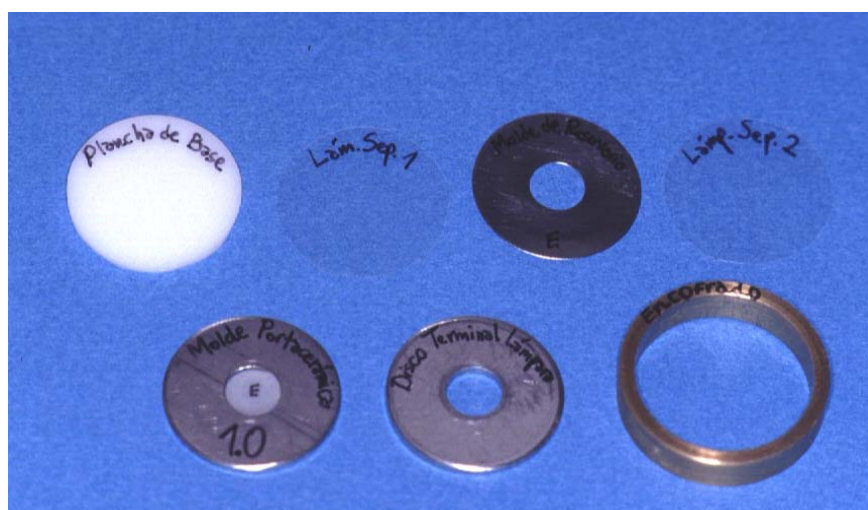
Figura 24. Componentes (piezas) del dispositivo cilíndrico de polimerización
