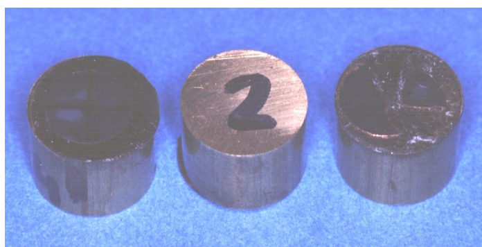
Figura 31. Metalización de muestra (cuadrante 2)
