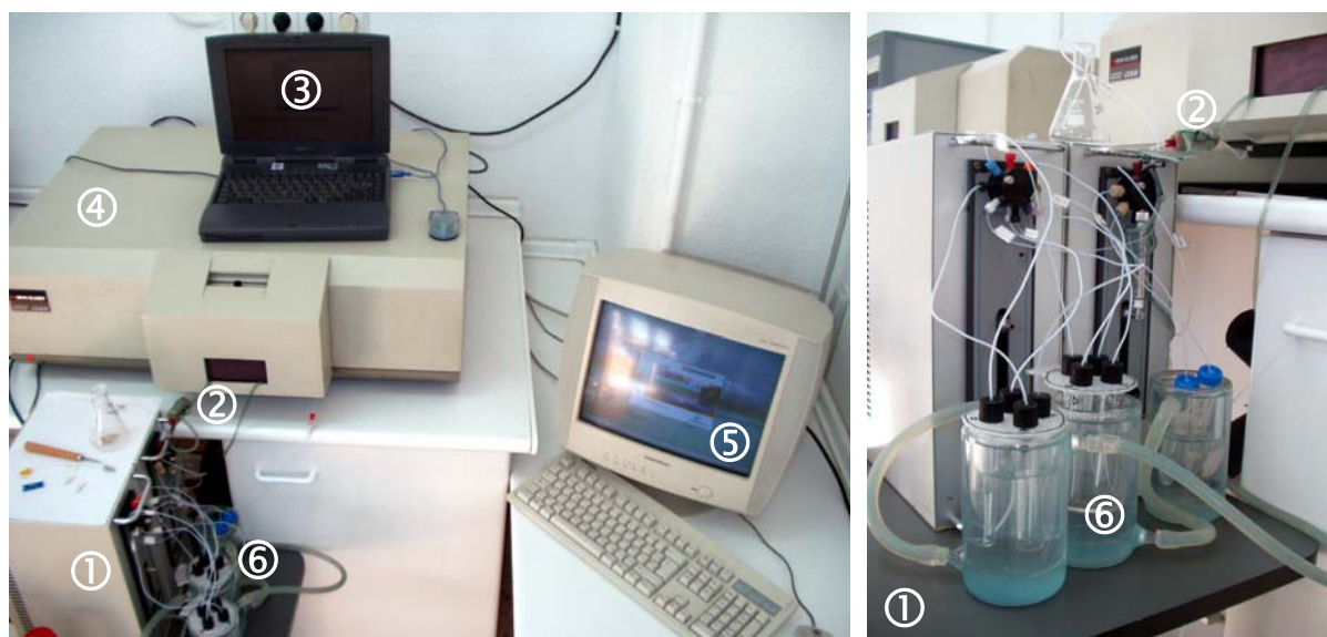
Figura 85. Imagen del sistema de medida utilizado para las medidas en flujo con el inmunosensor: 1. sistema de control y manejo de fluidos, 2. inmunoreactor, 3. ordenador de control del sistema de inyección, 4. espectrofluorímetro 5. ordenador de control del fluorímetro, 6. disoluciones termostatizadas de reactivos, patrones de calibrado y/o muestras.
