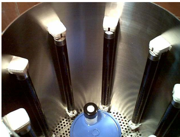
Figura 46. Imagen del reactor fotoquímico utilizado para la polimerización de los polímeros de impronta molecular (longitud de onda de excitación 350 nm).
