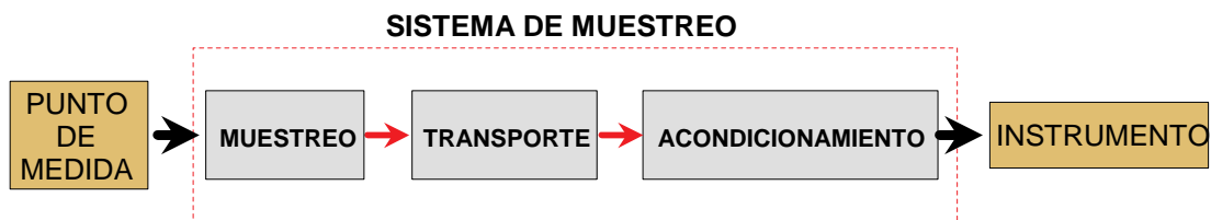
Figura 3-1. Diagrama general de objetivos de un sistema de muestreo, (Fissan y Schwientek, 1987).
