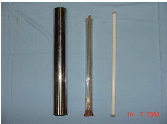
**Foto 19.-** Portacatéteres. El de la izquierda, metálico; el central de vidrio y el de la derecha de material plástico, años 1950-1965
