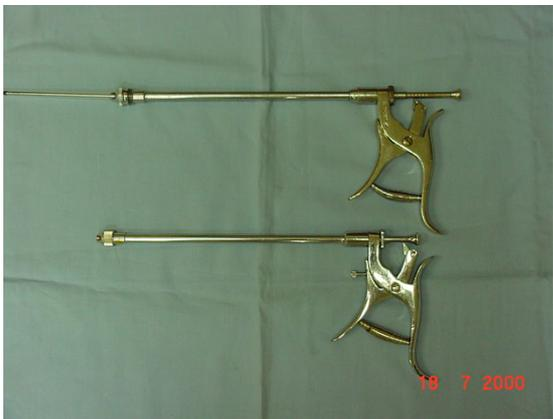
*Foto 5.- La denominada por Carbonero "pistola inseminadora" se componía de jeringa y catéter para inseminación (1947). La superior es de patente argentina, según el modelo del Dr. García Mata; la inferior es de patente española, según las indicaciones de Carbonero. Se fabricó en la Fábrica de Armas de Toledo en 1950.*
