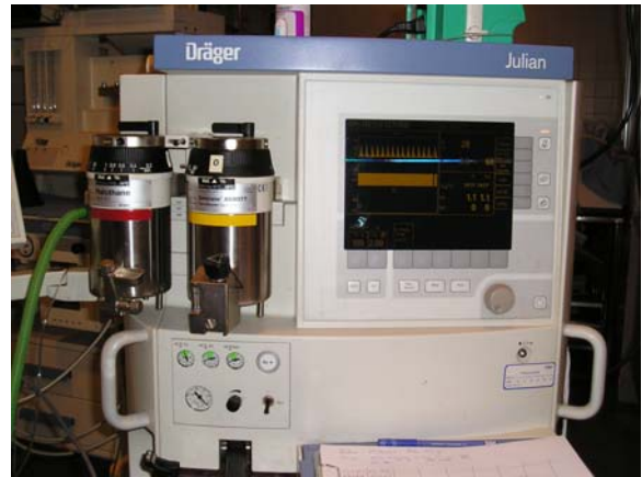
Fig. 9b. Unidad de trabajo y vaporizadores.
