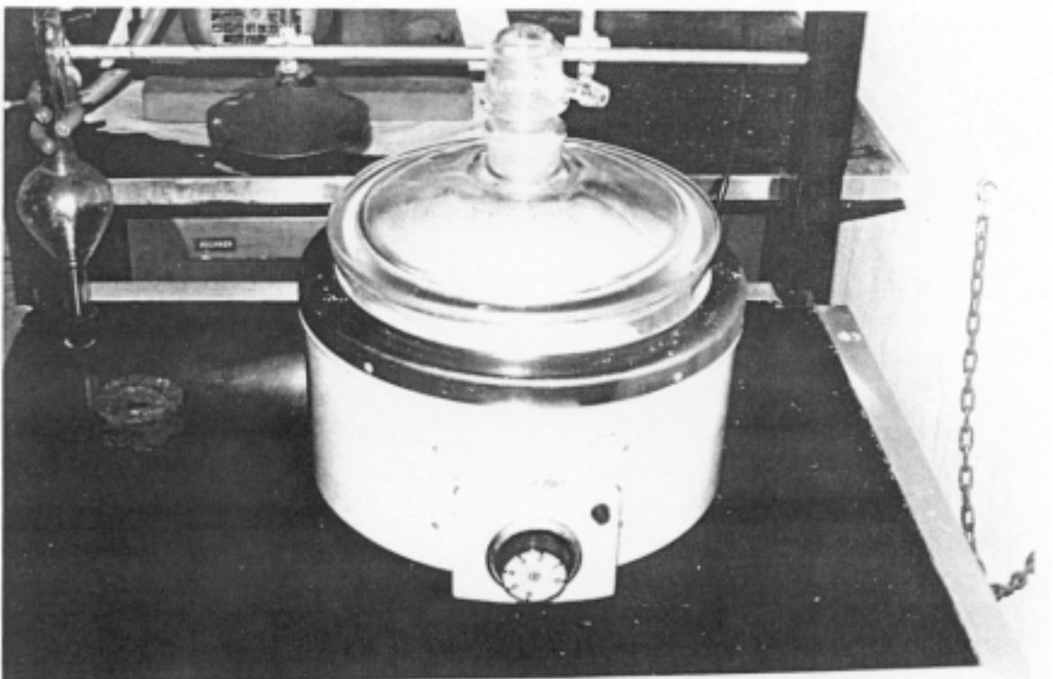
Fig. 15.- Campana de vacío donde se produce la desecación del cilindro.
