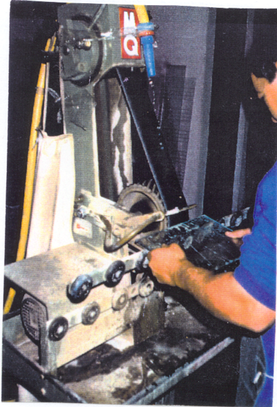
Fig. 61. Canteado de una plancha de vidrio con cinta de esmeril y agua.
