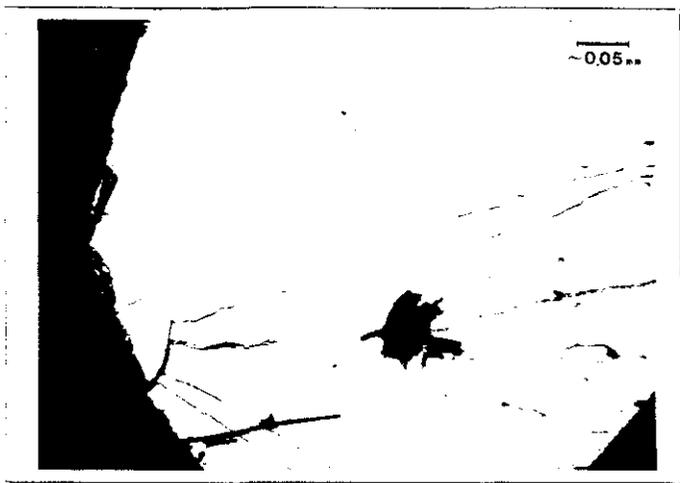
Foto II.3 Aspecto de la superficie del Cd<sub>0.55</sub>Mn<sub>0.45</sub>Te policristalino sin pulir. Las ligeras grietas que aparecen son producto de la exfoliación
