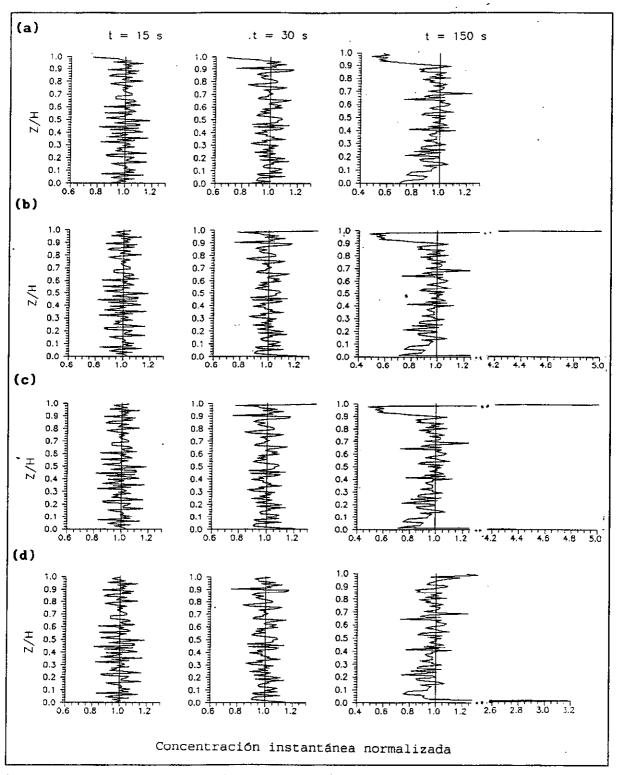
Figura 3.2.1.11. Concentraciones instantáneas normalizadas en función del tiempo t y la altura adimensional z/H, donde H es la altura máxima de la CBL. (a) no existe suelo ni altura máxima de la CBL. Considerando el suelo y altura máxima de CBL, las condiciones de contorno son: (b) reflexión en altura de la partícula, (c) reflexión en altura y signo de la velocidad de la partícula y (d) reflexión en altura y velocidad media de la partícula.
