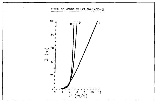
Figura 3.3.1.1. Perfiles de la velocidad horizontal del viento en las categorias B, D y E, considerando que su valor es de 4 m/s a 10 m de altura.
