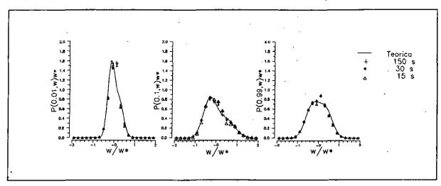
Figura 3.2.1.20. Distribuciones de velocidad en función del tiempo para las alturas adimensionales 0.01, 0.1 y 0.99. Los criterios se indican en la figura 3.2.1.19.
