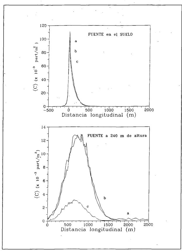
Figura 3.3.2.2.3. Concentración media entre el suelo y 50 metros. El intervalo de tiempo en el que se establece la concentración media es: (a) entre 30 y 20 minutos, (b) entre 20 y 10 minutos y (c) entre 0 y 10 minutos.
