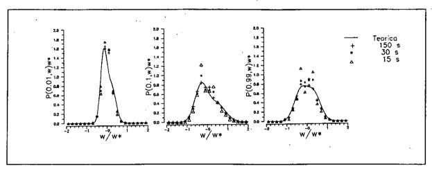
Figura 3.2.1.16. Distribuciones de velocidad adimensional en función del tiempo para las alturas adimensionales de 0.01, 0.1 y 0.99. Fluctuaciones iniciales de velocidad nulas respecto al caso f).
