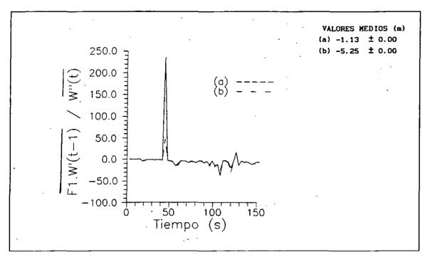
Figura 3.2.3.3. Evolución temporal de la relación entre la turbulencia en el instante anterior y su componente aleatoria. La desviación corresponde (a) Hanna (1982) y (b) Venkatram (1988).
