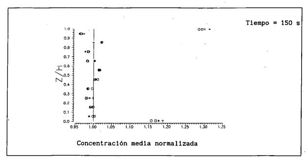
Figura 3.2.1.3. Distribución vertical media de partículas con fluctuaciones iniciales de velocidad nulas (o) y diferentes pasos temporales (o para  $\Delta t$ =0.03 s, \* para  $\Delta t$ =0.3 s y + para  $\Delta t$ =3 s) entre el instante inicial y 150 segundos.
