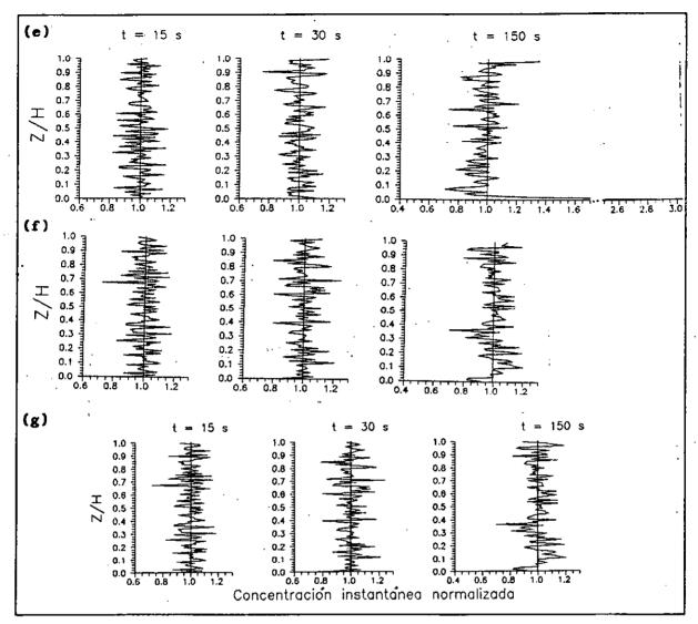
Figura 3.2.1.11 (cont.). Concentraciones instantáneas normalizadas en función del tiempo t y la altura adimensional z/H, donde H es la altura máxima de la CLC. (e) Icorporando gradientes verticales de varianza y escala de tiempo lagrangiana. (f) Incorporando a (e) el gradiente vertical de la velocida media. (g) Incorporando a (f) cambio de signo de la fluctuación de la velocidad tras la reflexión.
