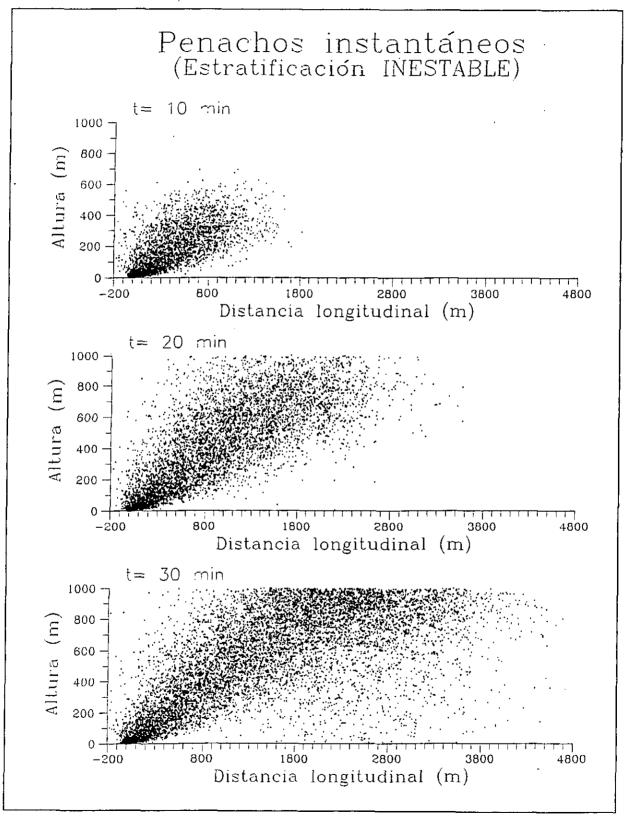
Figura 3.3.2.1.1. Penachos instantáneos a 10 min, 20 min y 30 min.
