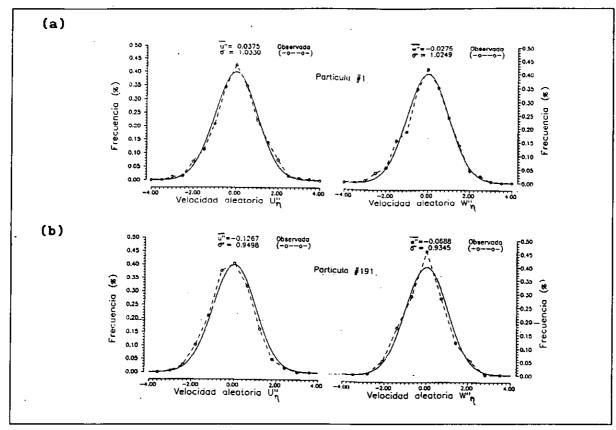
Figura 3.1.7. Función de densidad de probabilidad teórica N(0,1) (línea continua) y obsevada (línea discontinua) para las dos componentes aleatorias de la velocidad,  $u_{\eta}^{"}$  y  $w_{\eta}^{"}$ , en las partículas (a) #1 y (b) #191. Los valores de la media y desviación standard observadas están indicados en la parte superior.
