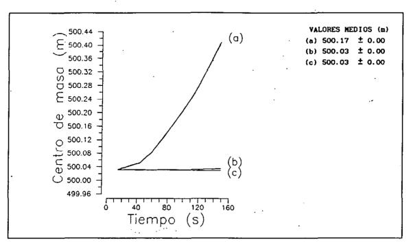
Figura 3.2.3.5. Evolución temporal del centro de masa para la velocidad de fricción (a) 0.2 m/s, (b) 0.05 m/s y (c) 0.01 m/s.
