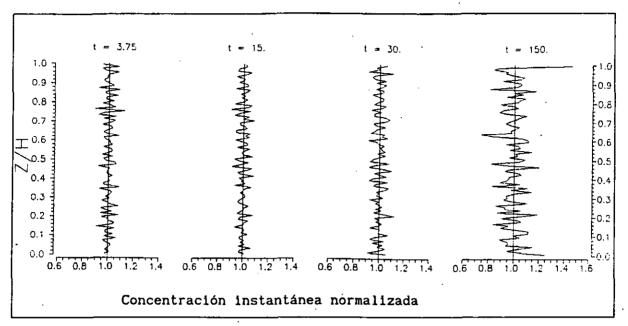
Figura 3.2.1.9. Evolución vertical y temporal, en segundos, de la concentración instantánea normalizada. Fluctuaciones iniciales de velocidad nulas.
