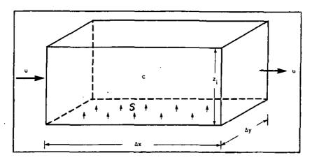
Figura 1.2.1.4.1. El modelo de única caja, donde S representa la emisión constante por unidad de área, u la velocidad del viento que es constante e inyecta en la caja aire limpio y c la concentración media dentro de la caja y variable en el tiempo.
