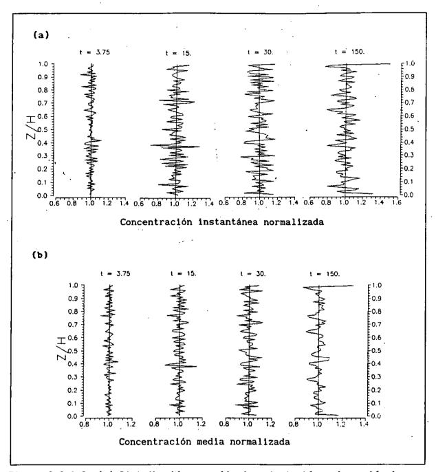
Figura 3.2.1.2. (a) Distribución normalizada e instantánea de partículas en los tiempos, en segundos, indicados por t. (b) Distribución normalizada y media de partículas entre el instante inicial y el tiempo indicado, en segundos, por t.
