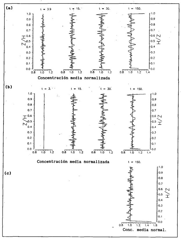
Figura 3.2.1.7. Evolución vertical y temporal, en segundos, de la concentración media normalizada, entre 0 y t, generada por el esquema con los siguientes pasos de tiempo (a) 0.3 s, (b) 3 s y (c) 30 s.
