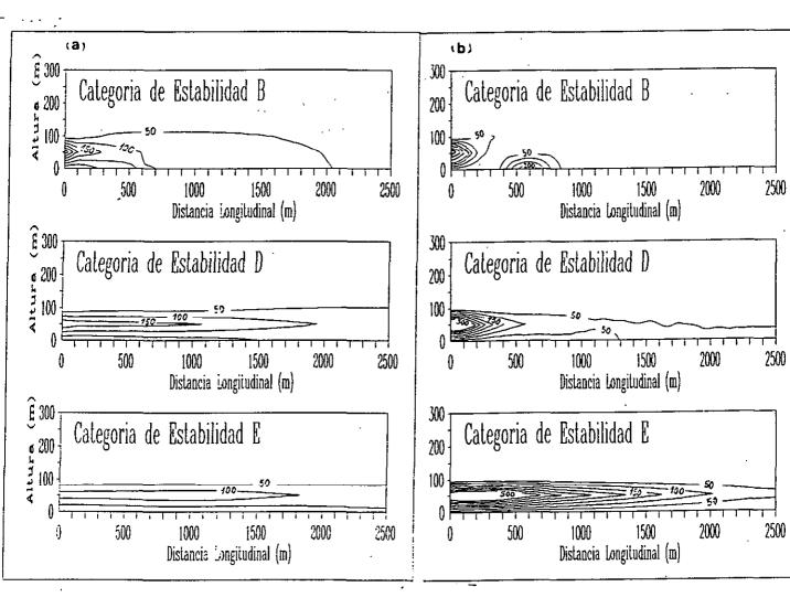
Figura 3.3.1.2. Isolíneas de concentración media de un penacho contínuo. (a) Modelo gaussiano y (b) modelo de partículas lagrangiano. La isolínea de concentración máxima es de 350  $\mu \text{g/m}^2$ , la mínima de 50  $\mu \text{g/m}^2$  y el intervalo es de 50  $\mu \text{g/m}^2$ .
