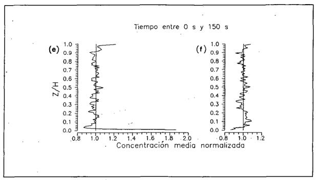
Figura 3.2.1.14. Evolución vertical de las concentraciones medias normalizadas desde 0 a 150 s. (e) Condiciones de contorno de reflexión en altura y cambio de movimiento y velocidad media de arrastre, (f) incorporando a (e) el gradiente de la velocidad media.
