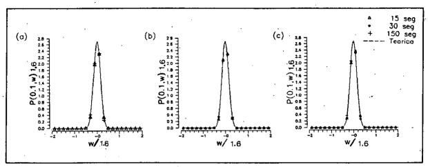
Figura 3.2.2.3. Distribución de la velocidad adimensional w/1.6 en función del tiempo t para la altura adimensiona z/H=0.100. Los pasos de tiempo son: (a) 3 s, (b) 0.3 s y (c) 0.03 s.
