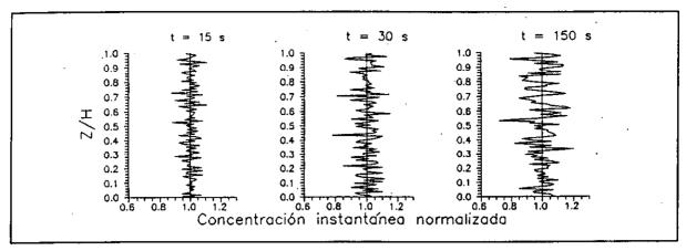
Figura 3.2.2.5B. Distribución vertical de la concentración instantánea normalizada en función del tiempo t. La desviación estándar de Pasquill (1974).
