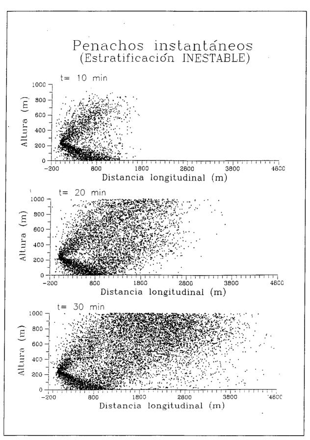
Figura 3.3.2.2.1. Penachos instantáneos a 10 min, 20 min y 30 min.
