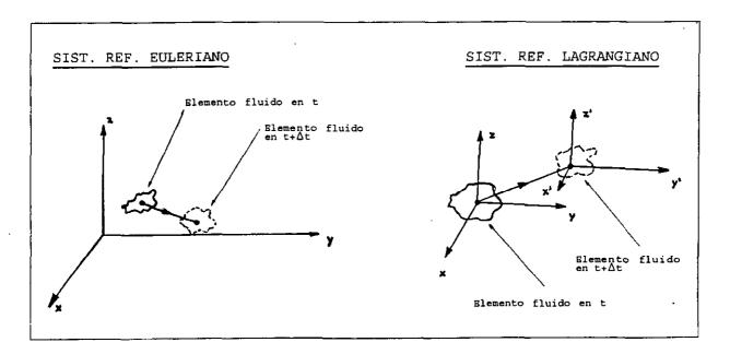
Figura 1.2.1. Sistemas de referencia euleriano y lagrangiano en el movimiento atmosférico.
