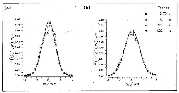
Figura 3.2.1.1. Evolución temporal de la distribución de velocidad de las partículas generada por el esquema entre (a) las alturas de 90 m y 110 m y (b) las alturas de 240 m y 260 m. Las líneas contínuas respresentan las pdf teóricas a las alturas de 100m y 250 m.
