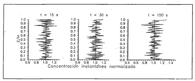
Figura 3.2.1.17. Evolución vertical y temporal de la concentración suponiendo que la velocidad media ascendente es 0.6 y y la descendente es de -0.4 w para el caso g).
