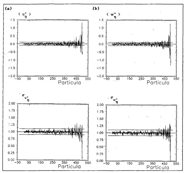
FIGURA 3.1.3. Valor medio y desviación standard de la componente aleatoria de la velocidad, (a)  $u_{\eta}^{"}$  (b)  $w_{\eta}^{"}$ , para cada partícula. Valor inicial de la serie aleatoria igual a 1, n igual a 120 y el generador es GO5FAF.
