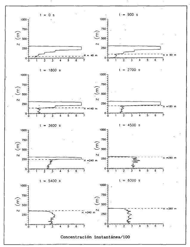
Figura 3.2.4.1. Evolución en el tiempo, t, de la concentración vertical instantánea de partículas con el avance de la capa de mezcla. La concentración se referencia a una concentración igual a 100 part/m.
