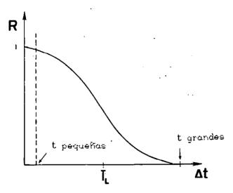
Figura 1.2.2.1. Función de autocorrelación en el tiempo.
