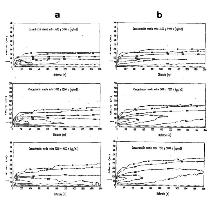
Figura 3.3.4. Isolíneas de concentración media cada treinta minutos entre los periodos de tiempo indicados (s). (a) Suponiendo un perfil gaussiano para la velocidad vertical y (b) siguiendo las indicaciones propuestas para condiciones convectivas.
