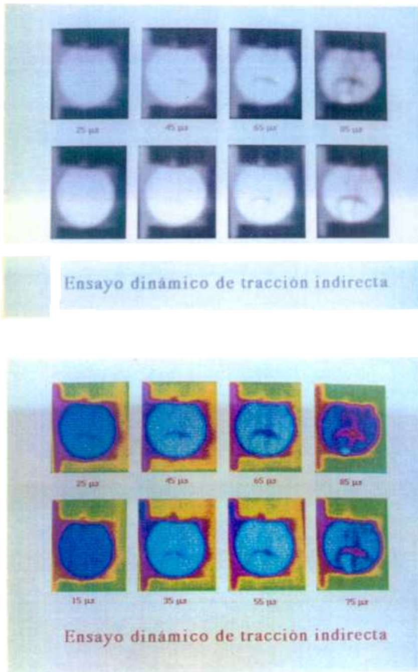
Figura 4.12 Imágenes registradas a alta velocidad durante un ensayo de tracción indirecta en carburo de silicio. Intervalo temporal 10 \mu\text{s}
