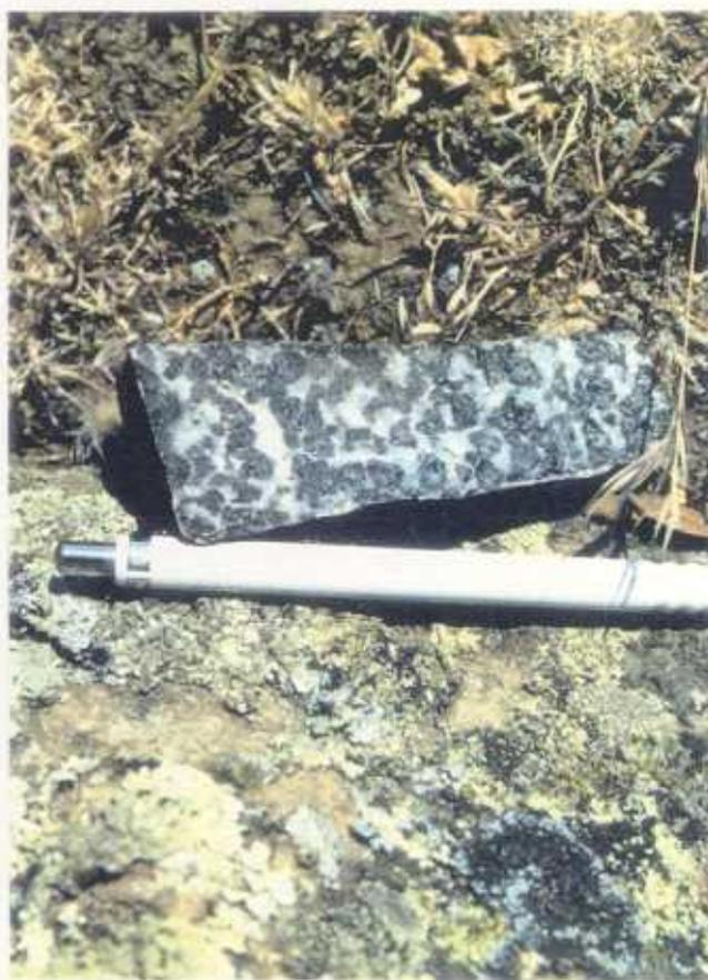
Figura 7.5.- Aspectos de la mineralización de cromita. (A) Afloramiento de cromita y detalle del mismo en las serpentinitas de Cabeza Gorda; (B) Fragmentos no "in situ" de cromita en las serpentinitas de Cerro Cabrera (proximidades del "Cortijo del Cuco").
