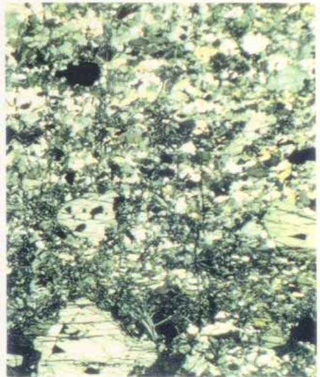
Figura 6.5 Dos aspectos de hornburgitas, con abundante anfíbol en las rocas ultrabásicas de la zona de Mellid. (A) Textura granular. (B) Roca foliada con fenocristales de anfíbol. L.T. Nícoles paralelos (izda) y cruzados (dcha). Escala= 0,25 mm.
