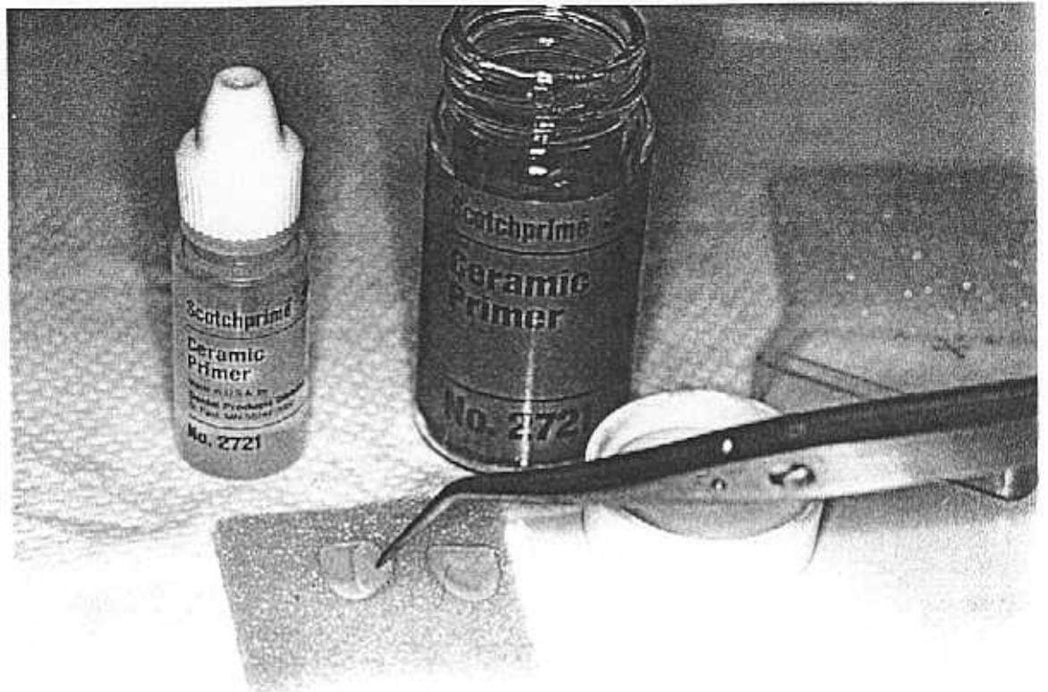
Figura 63. Aplicación del silano SCOTCHPRIME<sup>®</sup>
