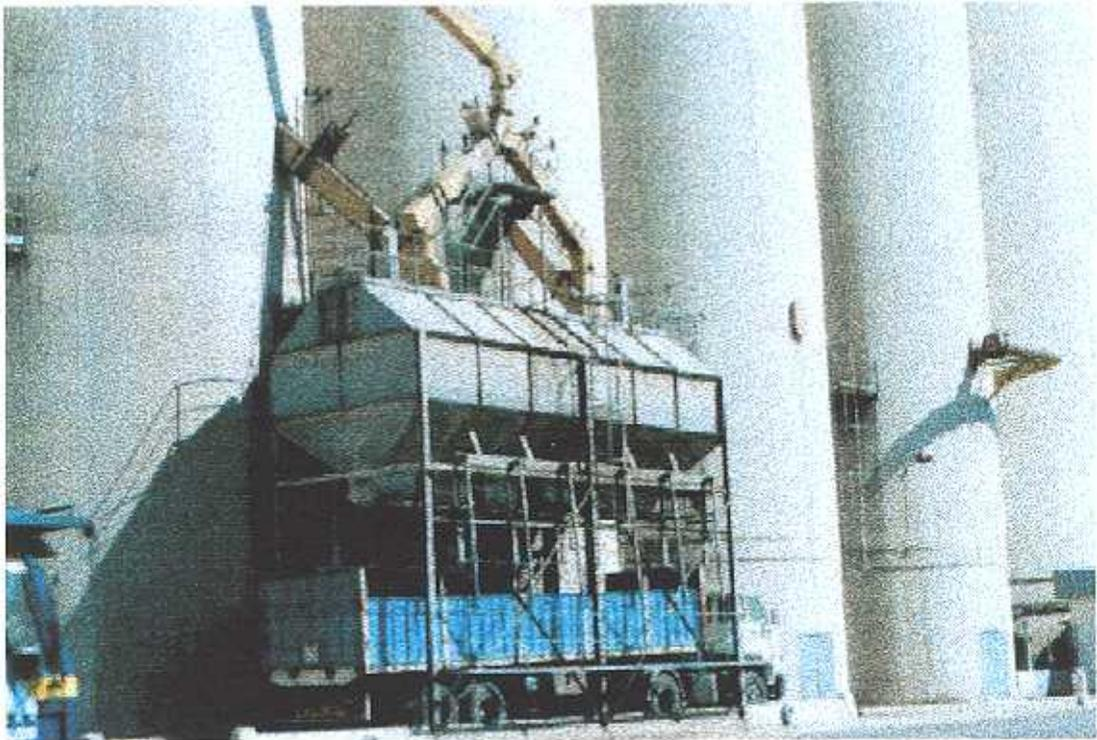
Fotografía 4.- Carga de camión automática (almacenamiento en silos).
