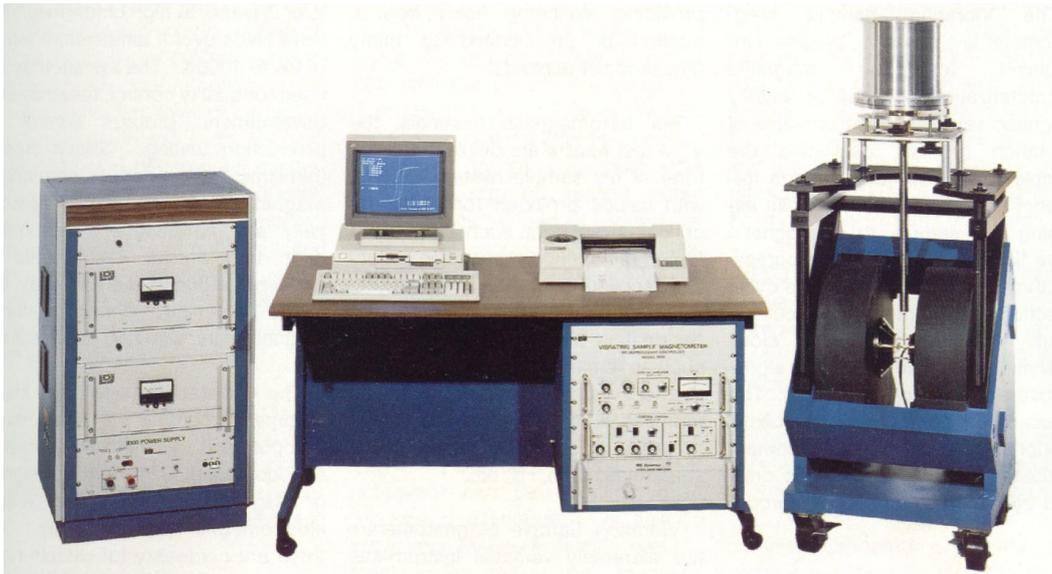
Figura 2.13: Magnetómetro de muestra vibrante LDJ modelo 9600
