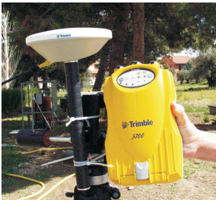
Figura 6.13: Receptor GPS Trimble 5700 y antena Zephyr.
