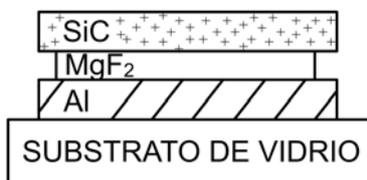
**Figura 5.11.** Esquema del espejo de banda ancha compuesto por tres láminas de Al, MgF<sub>2</sub> y SiC depositadas sobre un sustrato de vidrio.
