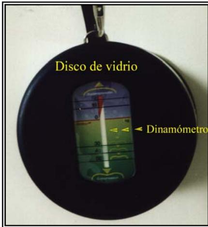
En la parte superior del disco ha sido introducido un dinamómetro para verificar la fuerza aplicada durante la compresión y la descompresión (Fig. 6).
