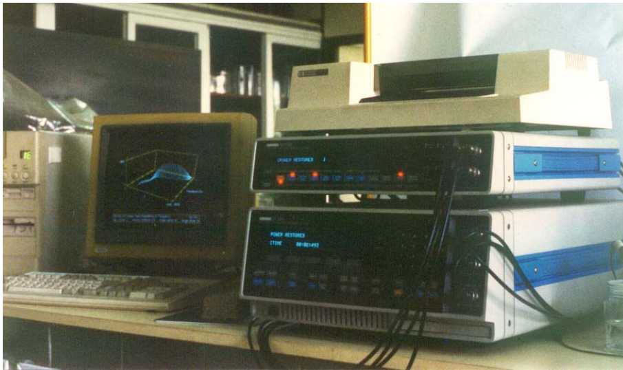
Figura 10. Fotografía de los equipos de corriente continua (DC) y corriente alterna (AC) utilizados.
