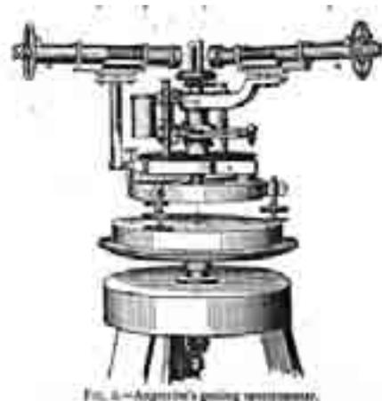
Fig. 60. Espectroscopio de difracción de Angström. 1899.
