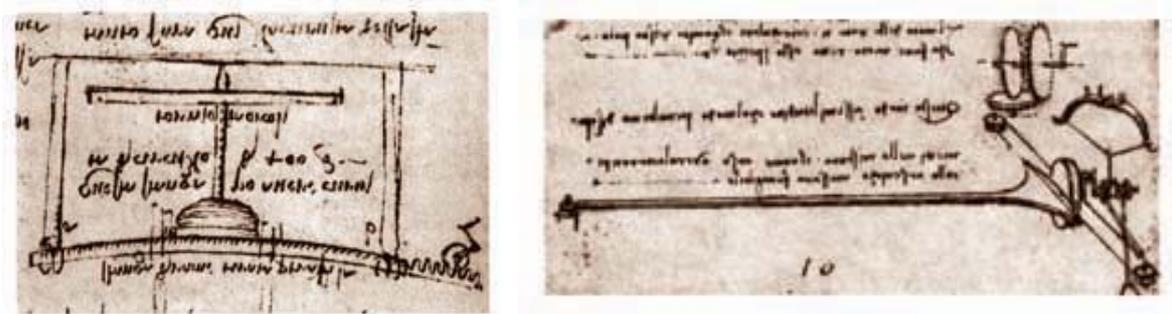
Fig. 14 y 15. Torno de alfarero para hacer espejos de gran distancia focal; y máquinas para esmerilar espejos, respect. Cuadernos de notas. Leonardo da Vinci.
