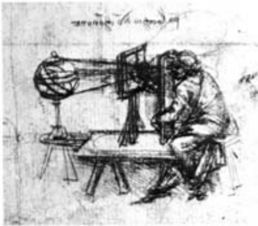
Fig. 13. Bastidor trasparente para dibujar. Codex Atlántico 1510. Leonardo da Vinci.
