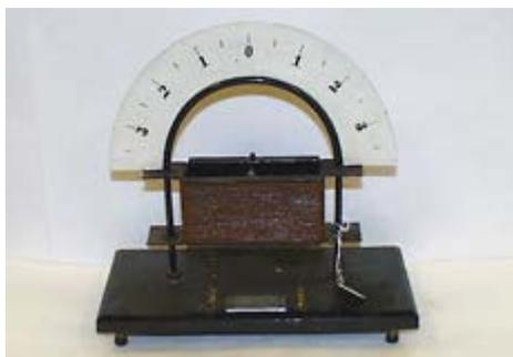
**CT/EDU/0376 Galvanoscopio** Galvanómetro de bobina fija colocada en una base de madera y enrollada sobre un soporte metálico. Este soporte sostiene también la escala en posición vertical. Lleva una etiqueta que dice "Galvanoscopio vertical\\Concepción Cerezo 119\\Mª Pilar López nº 122". ¿Será la última la fabricante y Concepción Cerezo la calle. Le falta la aguja.
