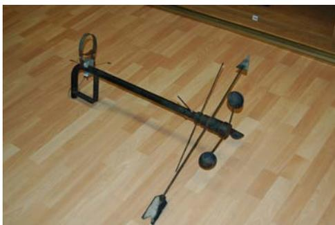
**CT/EDU/0743** Restos de una estación meteorológica: quedan parte de la veleta y del anemómetro. Es parte de un equipo de la casa ENOSA que tenía una pequeña caseta que se colocaba sobre unas patas de madera en el exterior de los centros escolares
