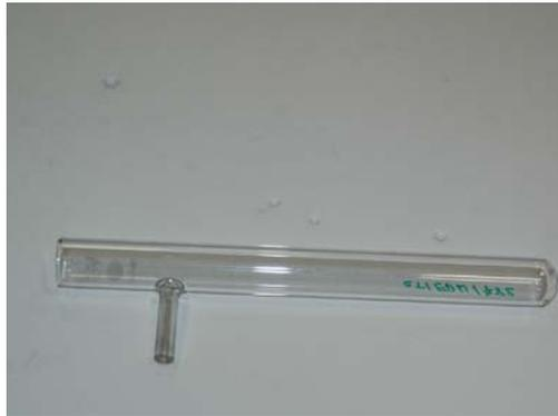
**CT/EDU/0782** *Tubo de ensayo con tubuladura lateral*
