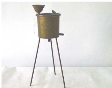
**CT/EDU/0360 Alcoholímetro** Parte de un alcoholómetro. Sólo se conservan el serpentín y el baño de refrigeración. Lleva un sello que dice «SAILERON\\ n° 3783\\alcoholómetro\\24 Rue Pavree Aumaris».
