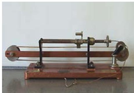
**CT/EDU/0065** Ergógrafo Permite medir el esfuerzo. Al desplazarse el indicador va señalando sobre el tambor de un kimógrafo.
