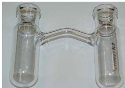
**CT/EDU/0767** ¿Dispositivo para montaje de una pila eléctrica con puente salino?
