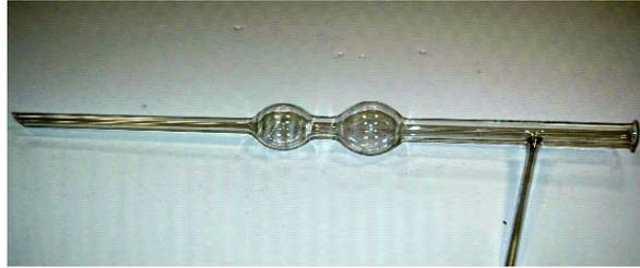
**CT/EDU/0783** Columna de fraccionamiento tipo Wurtz
