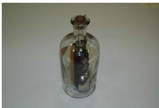
**CT/EDU/0749 Timbre Eléctrico** para funcionar en el vacío. Se trata de un timbre que está en el interior de un recipiente de vidrio transparente. Las conexiones están en el exterior del recipiente. Cuando se conecta y funciona si se ha colocado el dispositivo sobre la plataforma de la máquina de vacío se comprueba que no se oye porque el sonido no se transmite en el vacío
