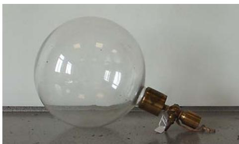
**CT/EDU/0051** Esferas de vidrio, que se utilizaban para determinar el peso específico de los gases. Se hacía el vacío, se pesaba vacío y después lleno del gas. Se calculaba el volumen por geometría.-53034 y 53033 de Max Kohl p. 402
