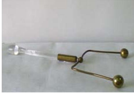
**CT/EDU/0108** Parte de un equipo de electrostática Por el aspecto pertenecería a un equipo de electrostática bastante antiguo. Para descargar condensadores, máquinas electrostáticas, etc. Horquilla metálica con soporte de vidrio.
