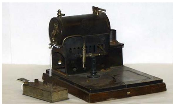
**CT/EDU/0386** Máquinas de vapor Se conservan dos máquinas de vapor antiguas. La [CT/EDU/0056](#) es una máquina situada sobre una base de madera que debería ir conectada con un tubo al [CT/EDU/0044](#) (un cilindro con regulador de Watt), que lleva el pistón. Se trata de una caldera bastante grande, con hogar y chimenea que conserva la válvula de seguridad y el manómetro. Lleva un rótulo que dice «Viuda de Aramburu, Príncipe 12. Madrid». La base está rota y aparecen como dos piezas separadas
