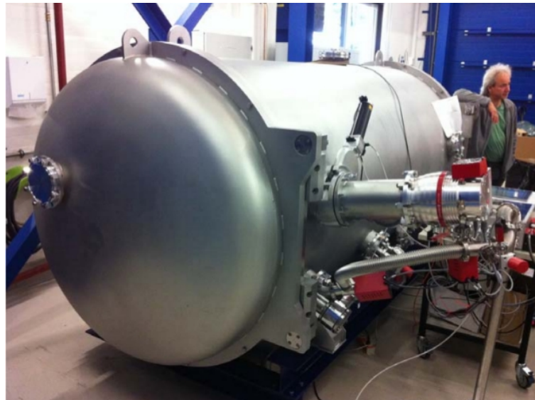
FIGURA 1.9: Tanque de vacío del espectrógrafo visible de CARMENES. Tomado de Quirrenbach y col. (2014).
